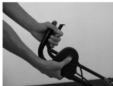
4. Atașați maneta de accelerație și strângeți șuruburile
