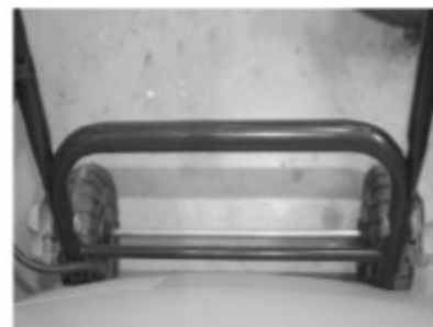
2. Introduceți șurubul cu cap fluture la partea inferioară a ghidonului.
