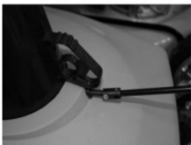
5. Atașați tija inferioară a gurii de descărcare, strângeți șurubul.
