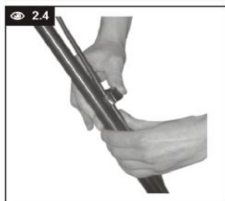
Fig. 2.2 Ukázka upevnění plynu
