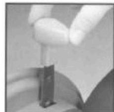
**Skärdjup.** Skärdjupet på kantskäraren kan ställas in i tre lägen, där största skärdjup är 38mm
