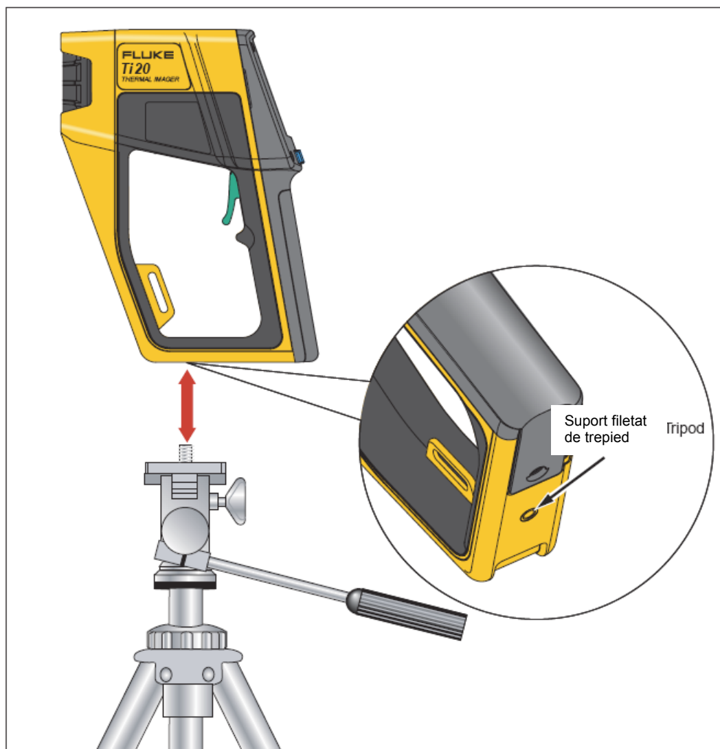
Figura 1-10. Montarea Camerei pe un trepied
