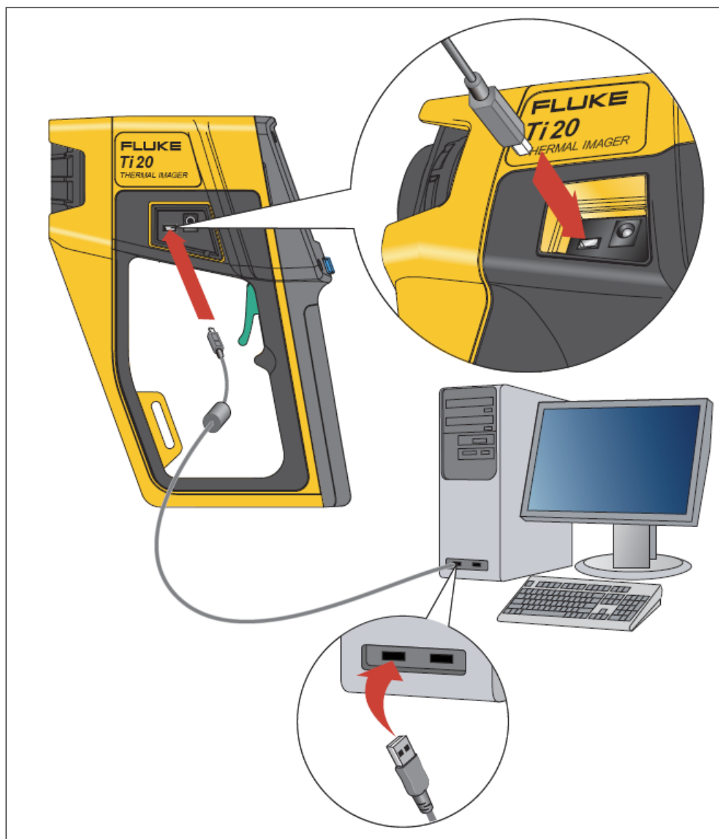
Figura 1-9. Conectarea cu ajutorul cablului USB
